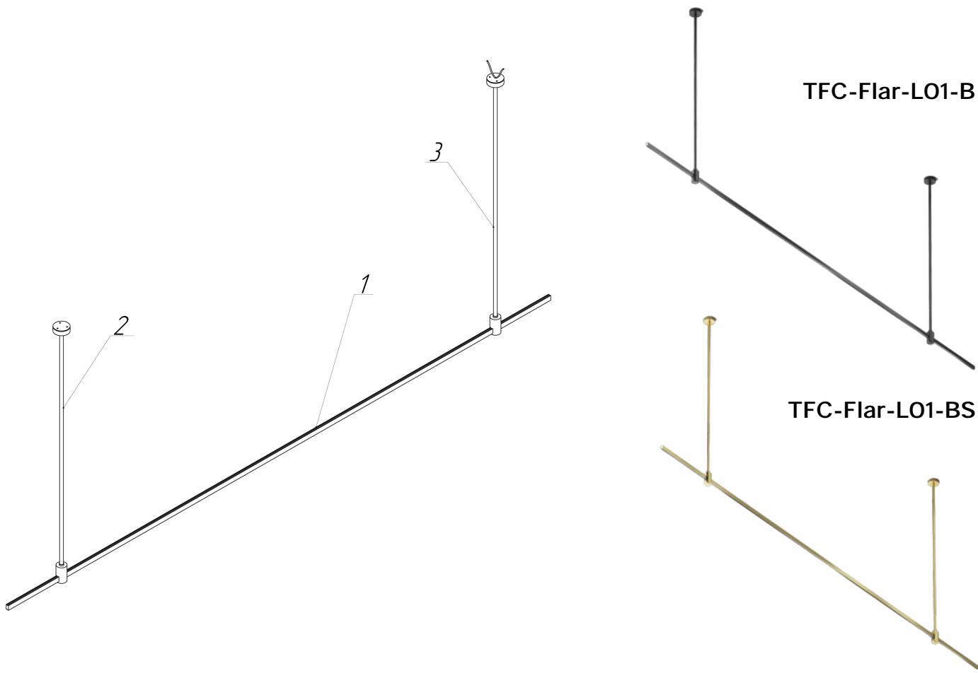
Подвесная конструкция системы Flarity прямой формы с жесткими подвесами Long H745 мм
