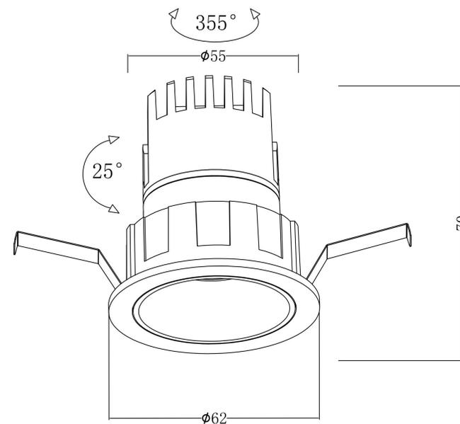
\*Ввиду особенности конструкции поворотного механизма при установке в натяжной потолок возможно образование засвета на полотне натяжного потолка вокруг светильника.
