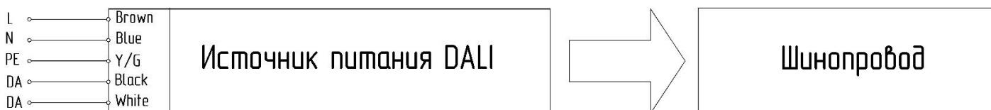
**Внимание!** Контакты DA источника питания подключаются напрямую к токоведущим жилам шинопровода для подключения шины DALI к светильникам DALI, установленных на данном шинопроводе.
