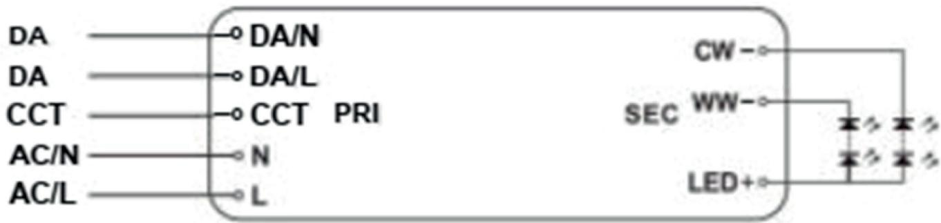
Данный источник питания подключается к шине DALI и может управляться, как обычной роторной панелью DALI в широковещательном режиме, так и настраиваться с помощью контроллера DALI, исходя из ваших потребностей.
