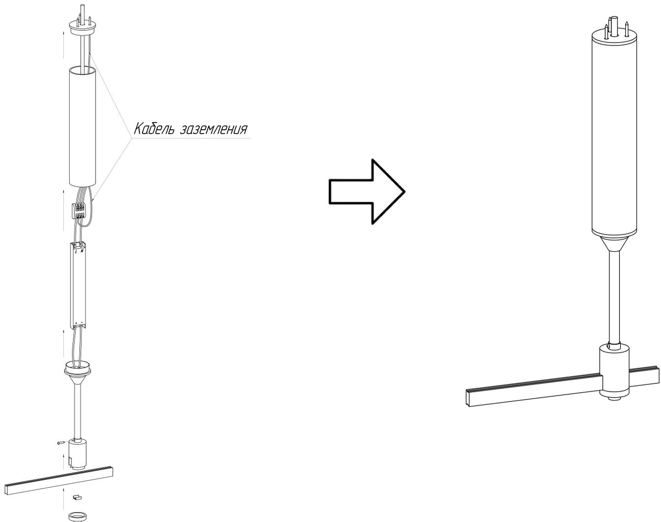
4. Установите светильник на шинопровод (см. раздел 7);
