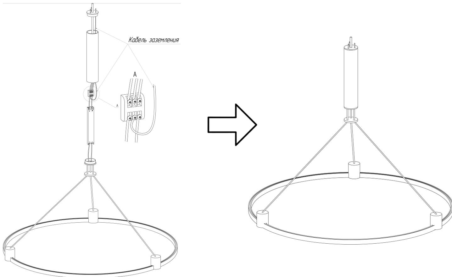
4. Установите светильник на шинопровод (см. раздел 7);
