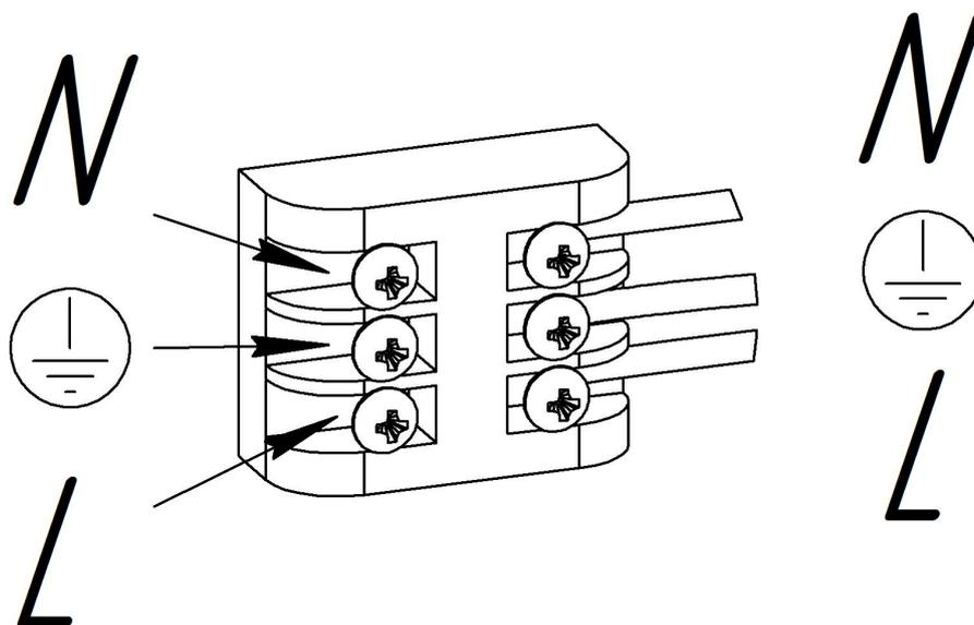
3. Подключите провода ввода питания к источнику питания. Полярность и цветность проводов значения не имеет. Прикрутите жесткий подвес с вводом питания к основанию и подключите его к шинопроводу;
