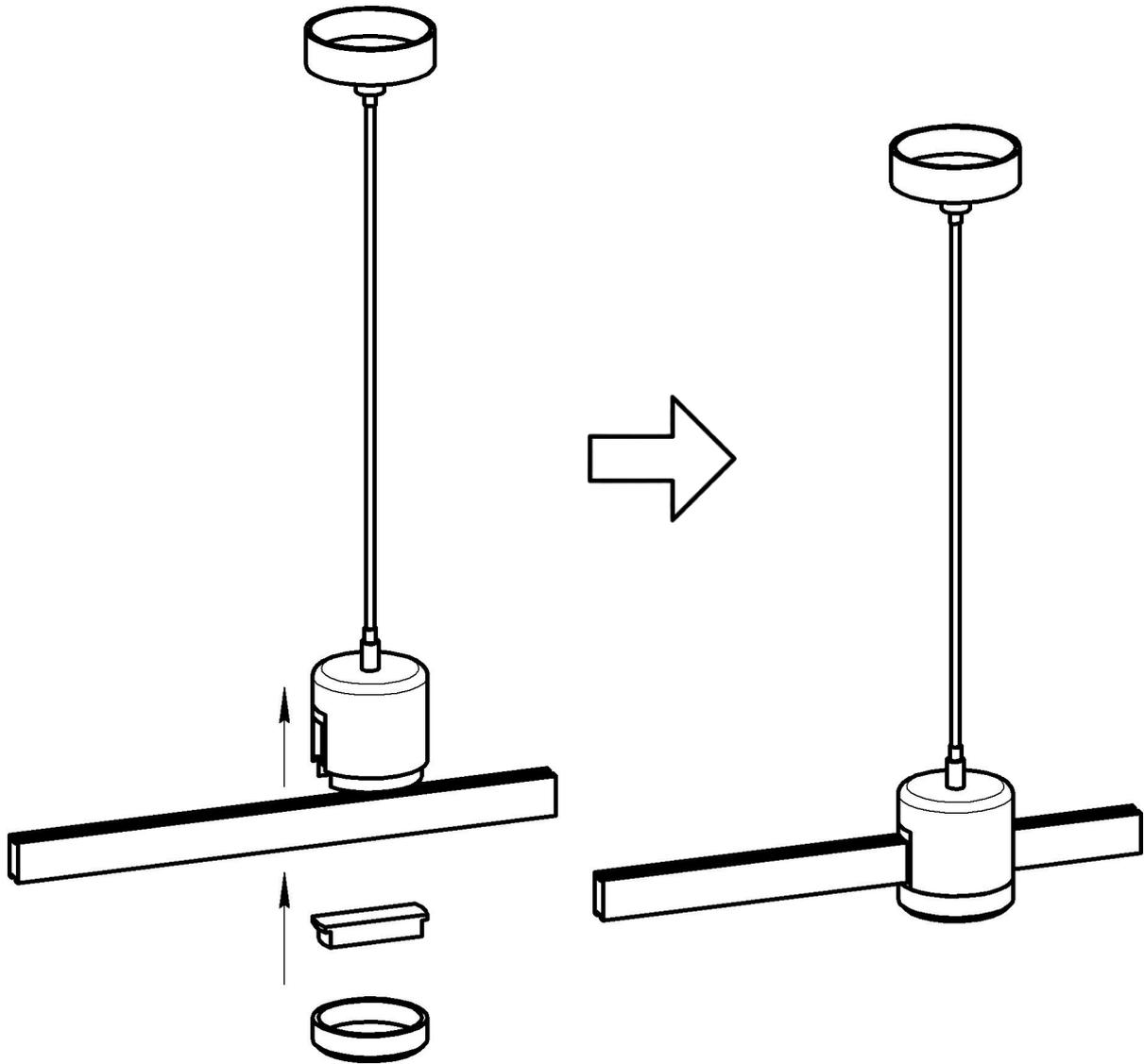
**Внимание!** Максимально допустимая нагрузка на трос для подвешного монтажа 5 кг на метр.
