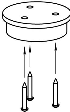
2. Разберите потолочную чашу и подключите источник питания согласно обозначениям на нем. Подключите коннекторы к круглому шинопроводу, зафиксируйте трос и прикрутите конструкции к потолочному основанию. Отрегулируйте высоту светильника нажатием фиксатора и освобождавая нужную длину троса вверх или вниз;
