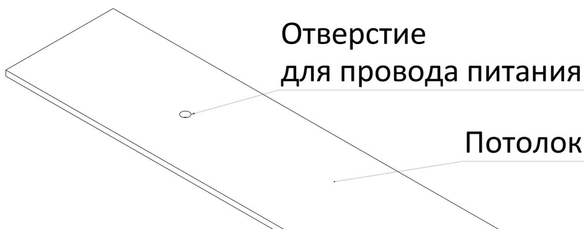
3. С помощью крепежных элементов смонтируйте светильник на потолке
