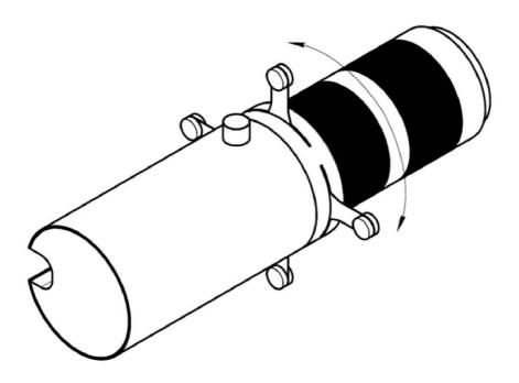
5. El mecanismo telescópico del sistema de lentes ajusta el ángulo de proyección de 20° a 35° acercando/alejando las lentes condensadoras incorporadas (ZOOM). ¡Atención! Véase el p. 3.
