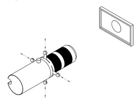
2. Un dispositivo especial para instalar filtros de luz de colores o una placa (gobo) con una plantilla de logotipos y varios dibujos.
