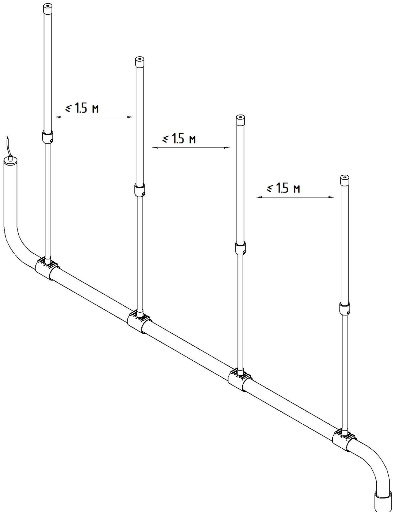
1. С помощью винта на жестком подвесе отрегулируйте высоту подвеса
