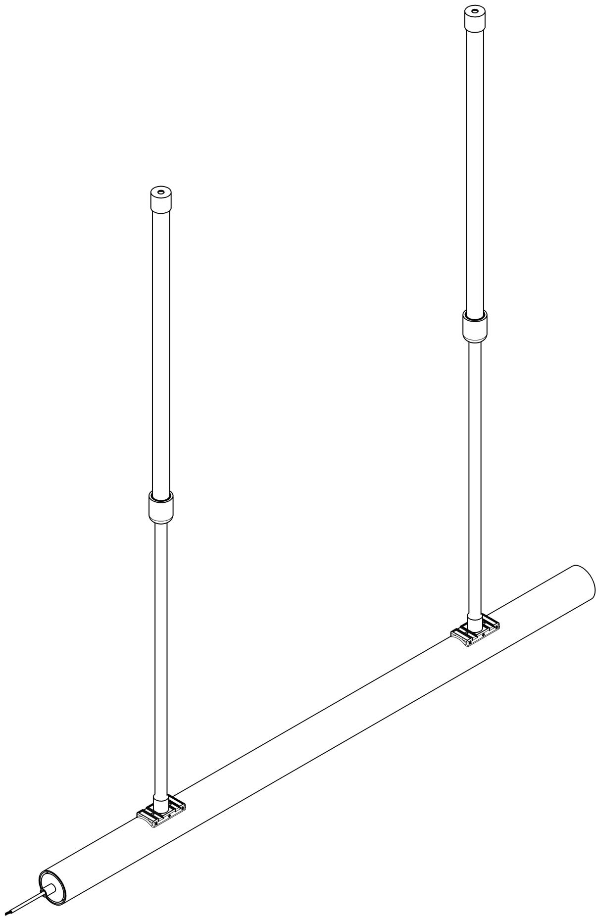
2. С помощью винта на жестком подвесе отрегулируйте высоту подвеса
