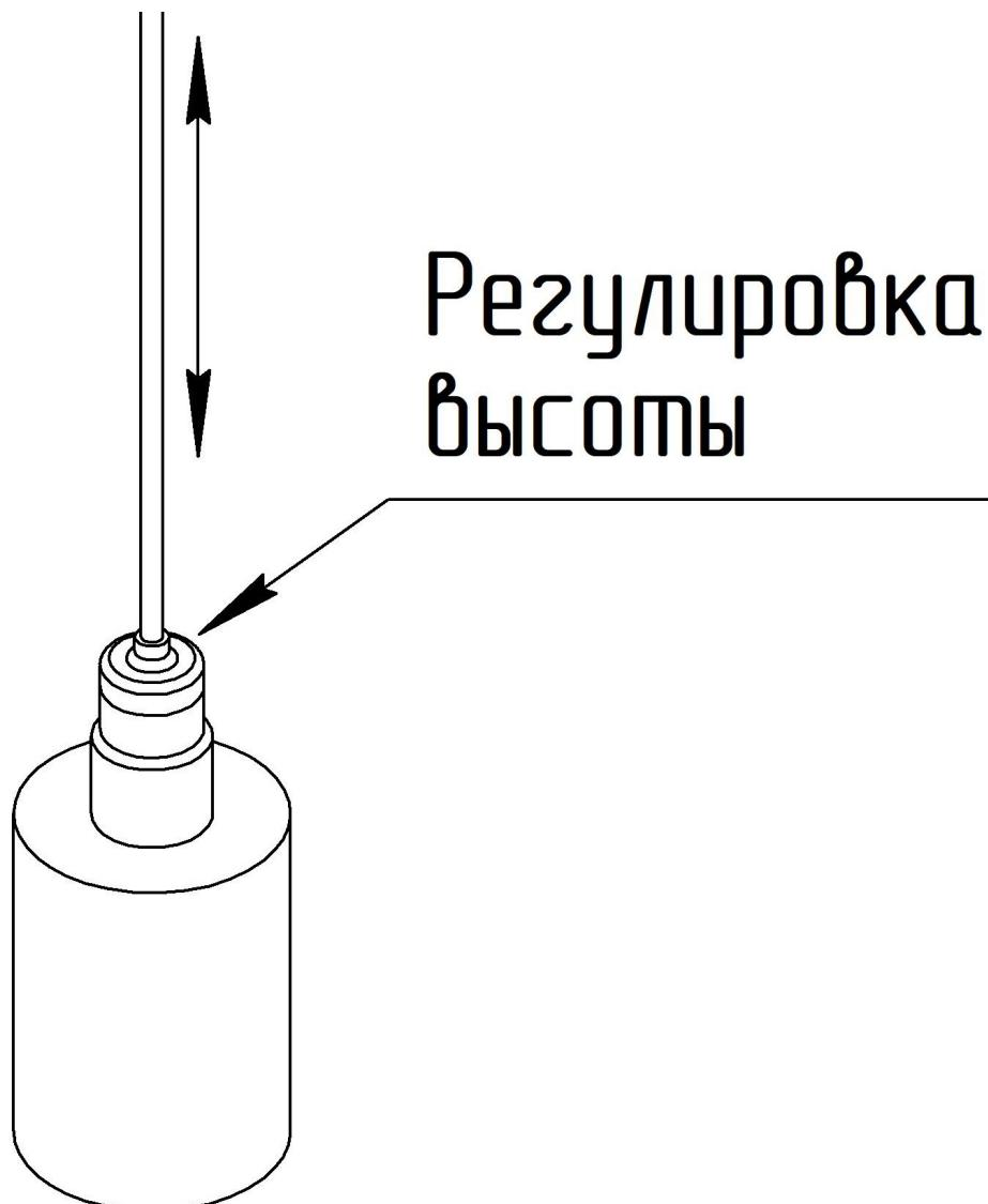
3. С помощью комплекта подвесов для горизонтального подвесного монтажа, соберите интересующую вас конструкцию и смонтируйте ее на потолочной поверхности, как указано на рисунках ниже
