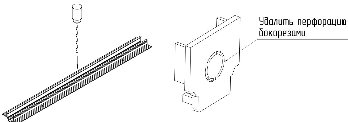
4. Продумайте интересующую вас конструкцию системы и с помощью комплектующих для встраиваемой системы, коннекторов питания и крепежных элементов смонтируйте ее на монтажной поверхности, например, как указано на рисунках ниже. аккуратно удалите в заглушке перфорацию бокорезами для ввода кабеля питания;
