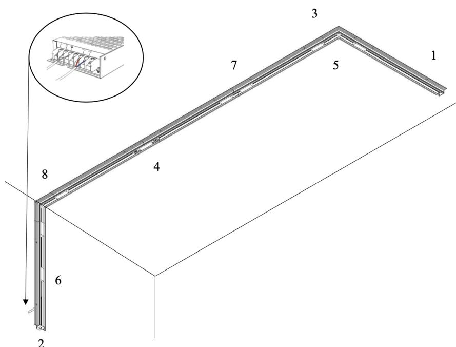
1. Извлеките токопроводящие дорожки. Нарежьте шинопровод согласно проектным размерам. Резка допускается в любом месте под углом в 90 градусов;
