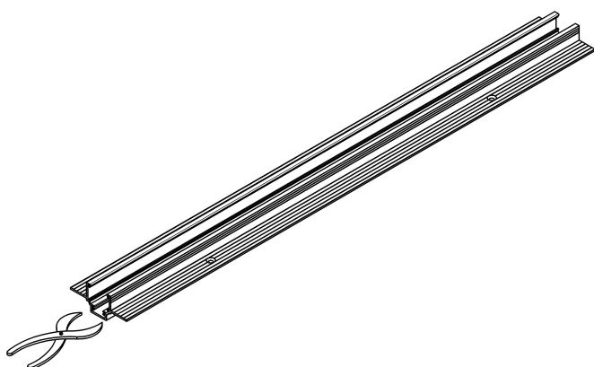
3. Просверлите отверстия для ввода кабеля питания в шинопроводе, снимите фаски или аккуратно удалите в заглушке перфорацию бокорезами для ввода кабеля питания;
