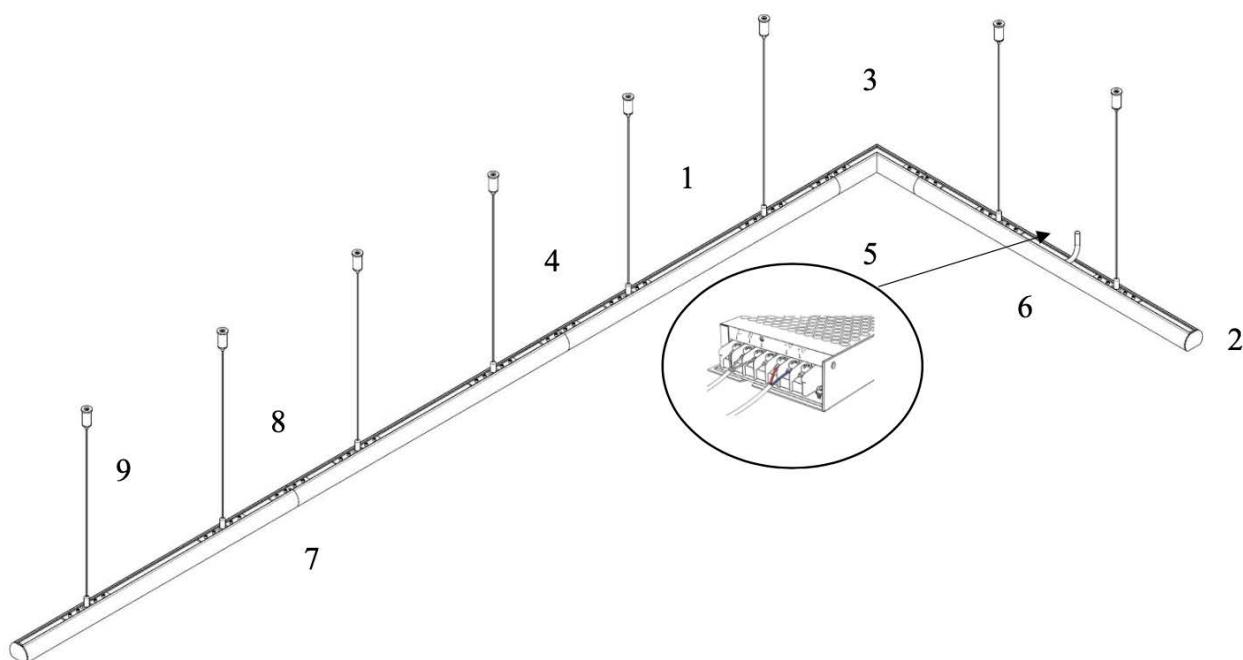
Пример конструкции с накладным-подвесным шинопроводом TRXM034-412 и вводом питания для выносного источника питания
