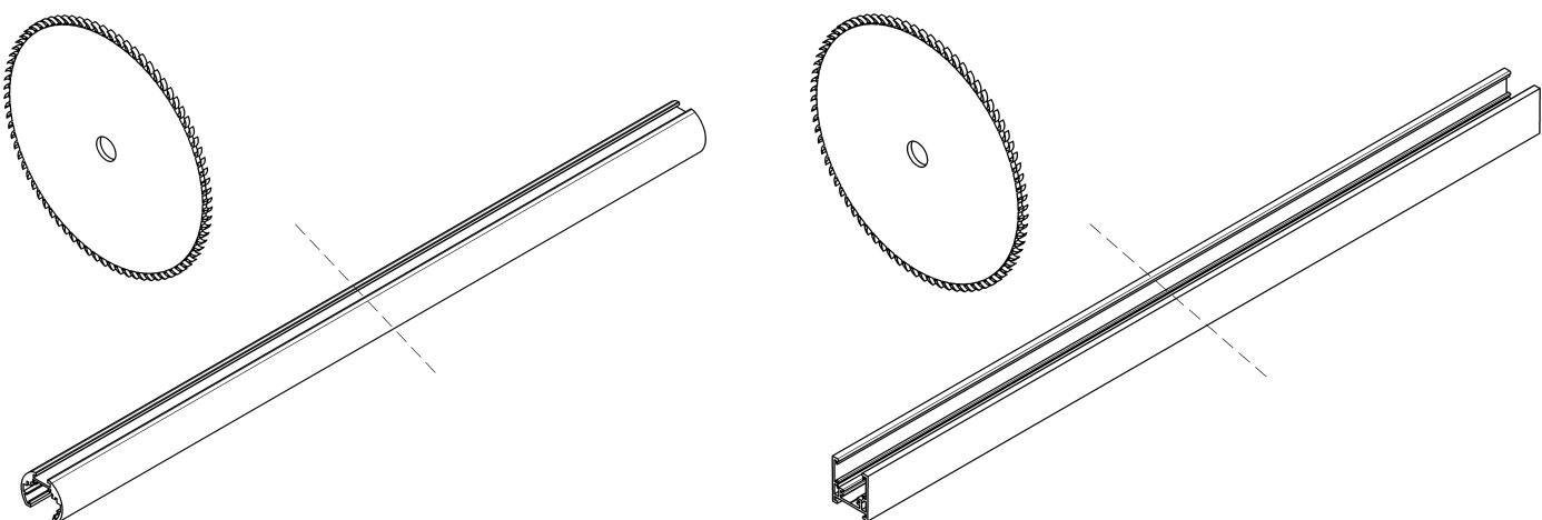
**Внимание!** Токопроводящие дорожки режутся отдельно от шинопровода также под 45 или 90 градусов. Проводить резку рекомендуется торцовочной пилой. Резка под 45 градусов допускается только в случае использования накладного-подвесного шинопровода TRXM034-412 и отсутствия угловых коннекторов. В качестве углового коннектора используется соединитель L-образный TRA034CL-21.
