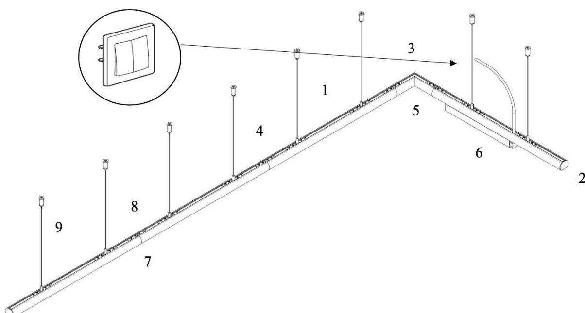
Пример конструкции с накладным-подвесным шинопроводом TRXM034-412 и встраиваемым источником питания
