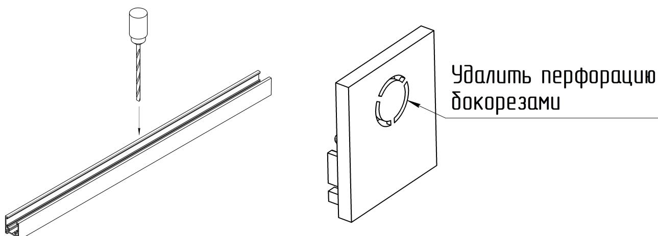
4. Продумайте интересующую вас конструкцию системы и с помощью комплектующих для накладной-подвесной системы, коннекторов питания, фиксаторов и крепежных элементов смонтируйте ее на монтажной поверхности, например, как указано на рисунках ниже.
