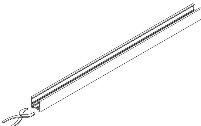
3. Просверлите отверстия для ввода кабеля питания в шинопроводе, снимите фаски или аккуратно удалите в заглушке перфорацию бокорезами для ввода кабеля питания;
