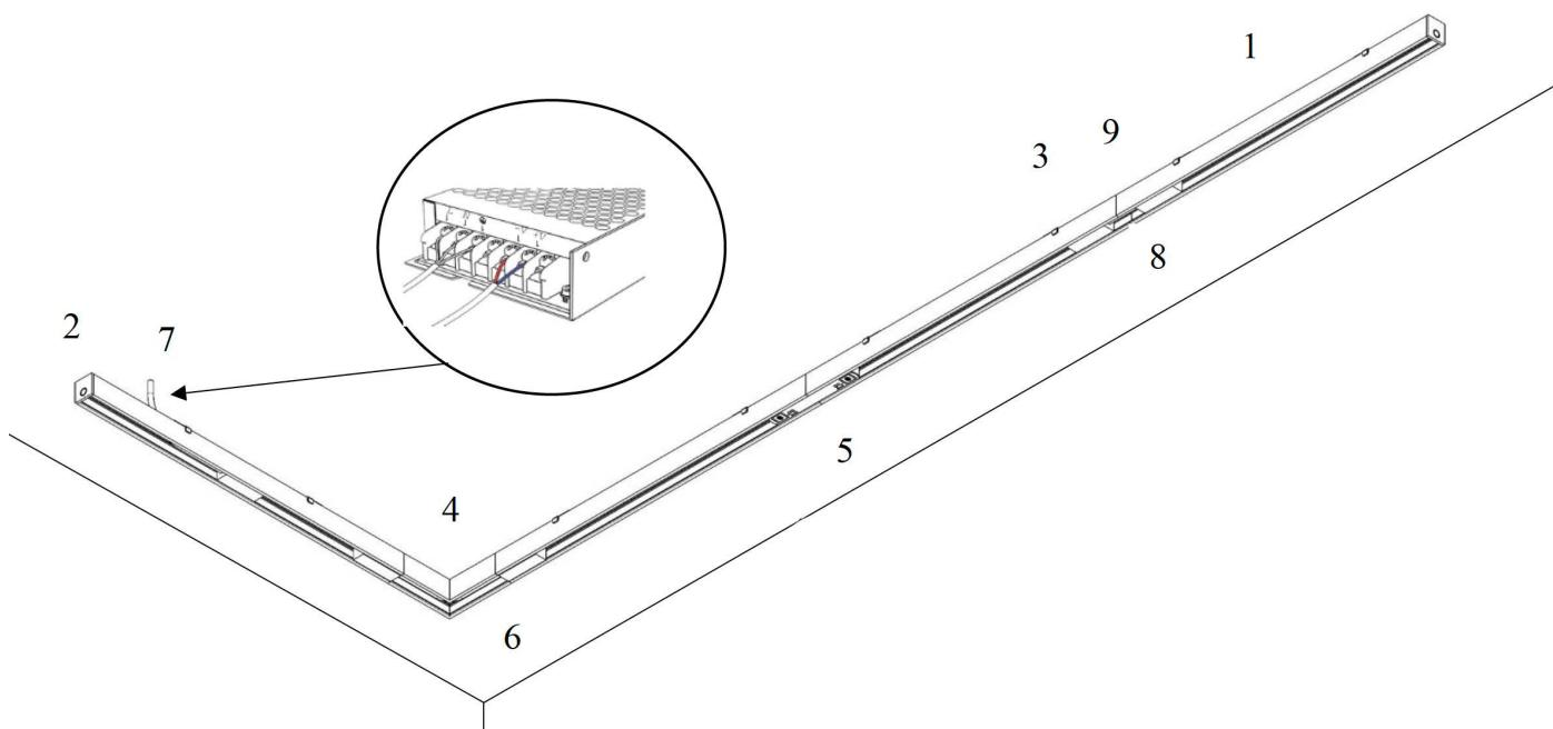
1. Извлеките токопроводящие дорожки. Нарежьте шинопровод согласно проектным размерам. Резка допускается в любом месте под углом в 90 и 45 градусов. Резка под 45 градусов допускается в случае отсутствия угловых коннекторов;
