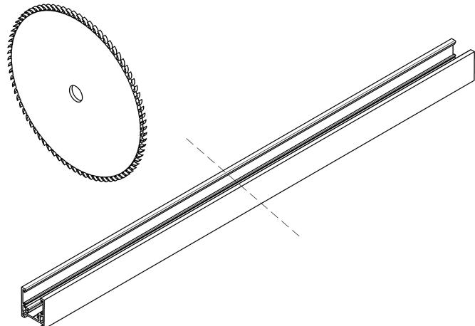
**Внимание!** Токопроводящие дорожки режутся отдельно от шинопровода также под 45 или 90 градусов. Проводить резку рекомендуется торцовочной пилой. Резка под 45 градусов допускается в случае отсутствия угловых коннекторов. В качестве углового коннектора используется соединитель L-образный TRA034CL-21.
