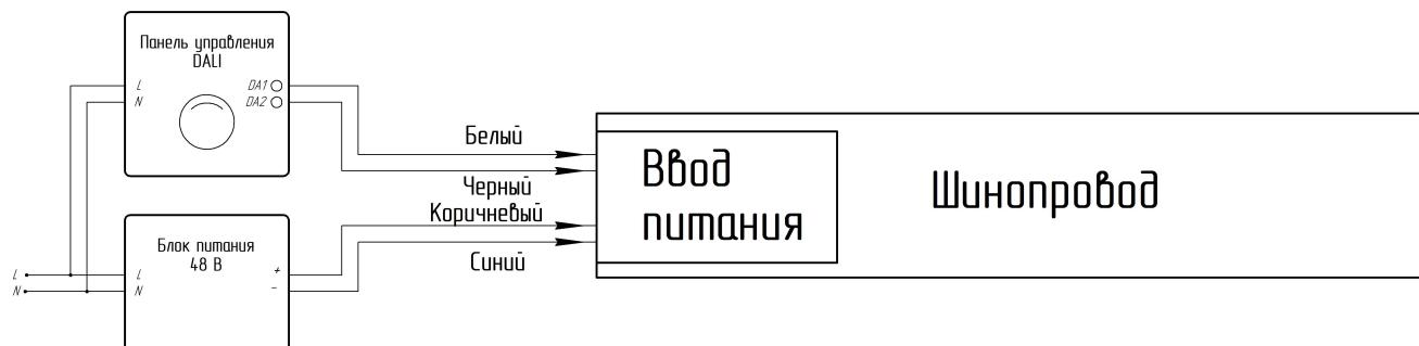
**Внимание!** Встраиваемые источники питания TRX034DR4-100/TRX034DR4-200 нельзя использовать для подключения светильников DALI, так как эти источники питания не имеют дополнительных контактов для подключения цифрового протокола DALI. Для подключения цифрового протокола DALI необходимо использовать выносные блоки питания с вводом питания.
