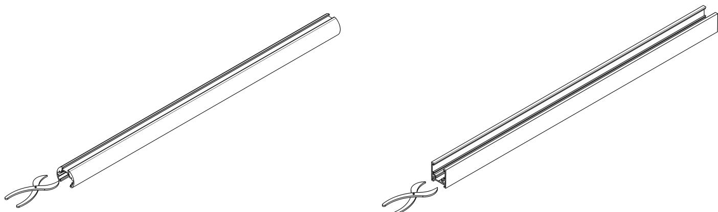
3. Просверлите отверстия для ввода кабеля питания в шинопроводе, снимите фаски или аккуратно удалите в заглушке перфорацию бокорезами для ввода кабеля питания;\*
