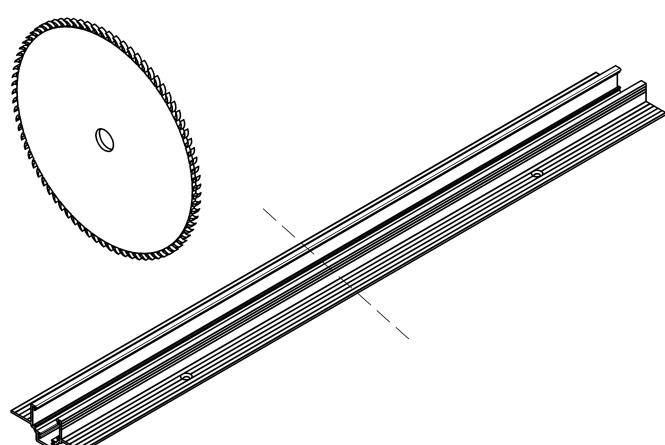
**Внимание!** Токопроводящие дорожки режутся отдельно от шинопровода под 90 градусов. Проводить резку рекомендуется торцовочной пилой.
