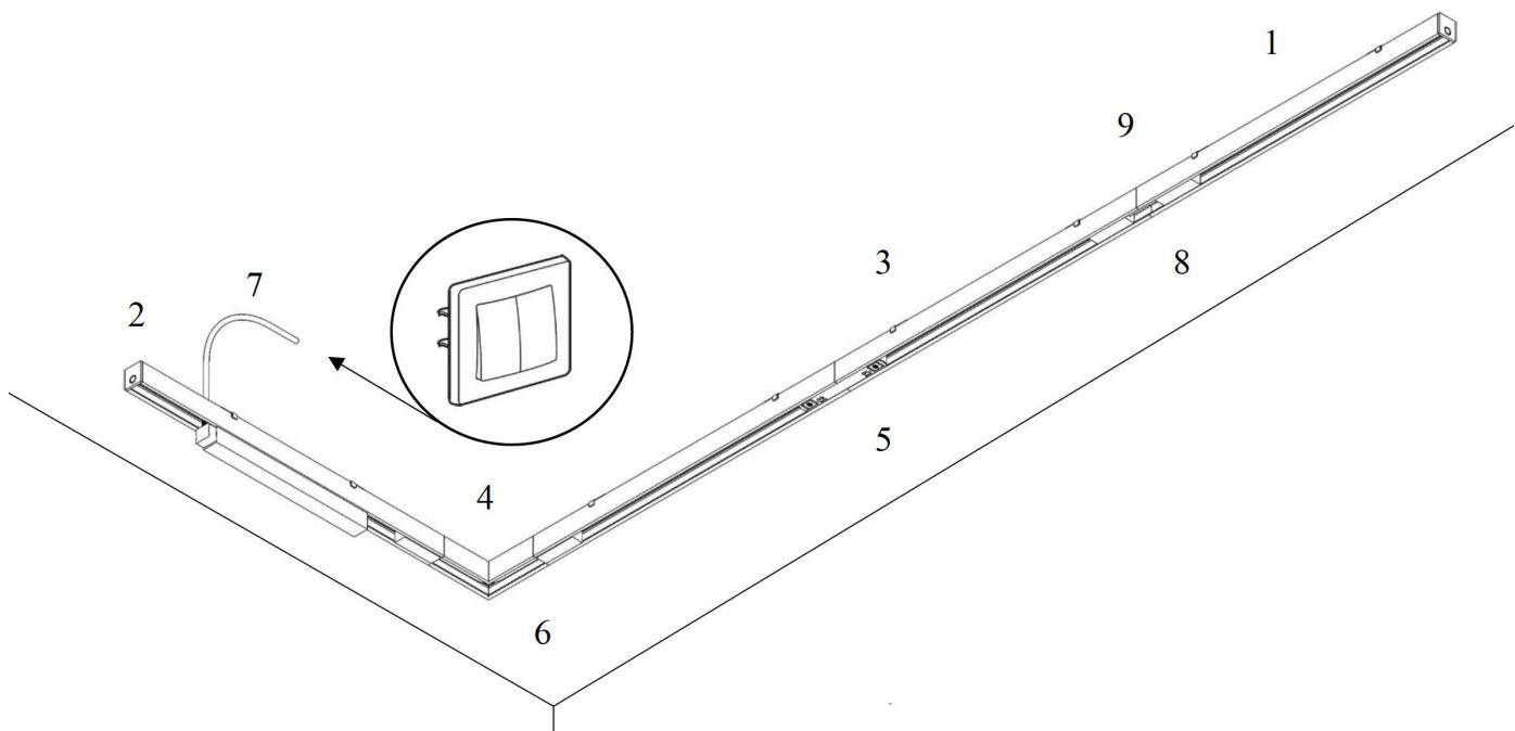
Пример конструкции с вводом питания для выносного источника питания
