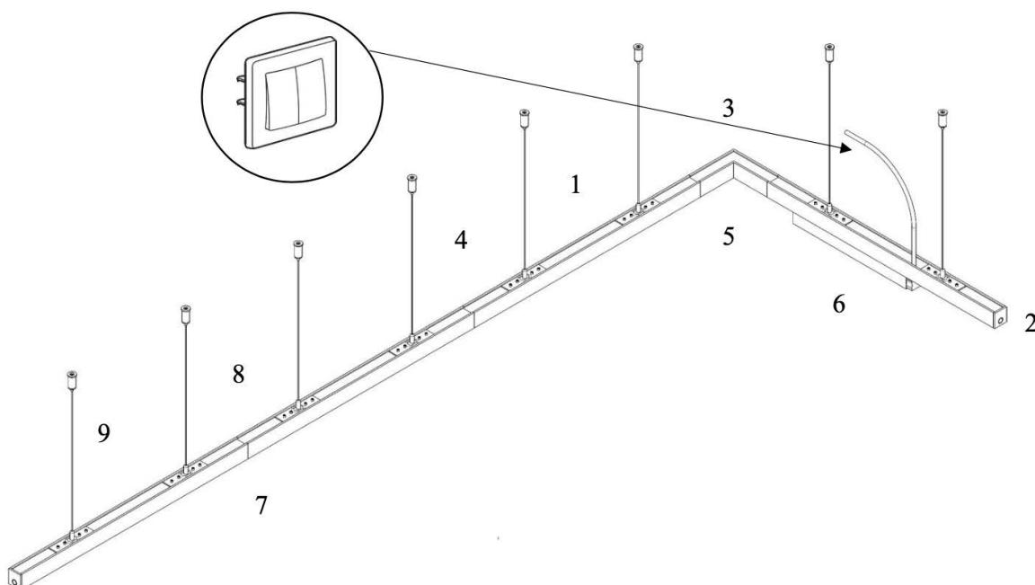
Пример конструкции с подвесным шинопроводом TRXM034-R-412 и вводом питания для выносного источника питания
