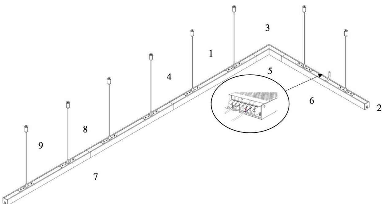
1. Извлеките токопроводящие дорожки. Нарежьте шинопровод согласно проектным размерам. Резка допускается в любом месте под углом в 90 и 45 градусов. Резка под 45 градусов допускается только в случае использования накладного-подвесного шинопровода TRXM034-412 и отсутствия угловых коннекторов; выносного источника питания
